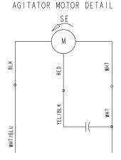
ALTERNATE AGITATOR MOTOR DETAIL FIG 2
